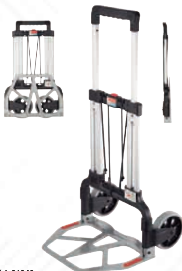
Cód. 81940 CARRETILLA ALUMINIO PLEGABLE. CARRIVAN Carga: 125 kgs. Aluminio. Nuevo sistema de doble anclaje que impide que las ruedas se cierren cuando la carretilla está en funcionamiento. Gran pala: 35X48,5 cms y altura:109 cms. Empuñadura amplia y ergonómica. Ruedas: 17 cms. de goma. Grosor plegada: 6,5 cm.. 56,25€ + 11,81 IVA = 68,06€
