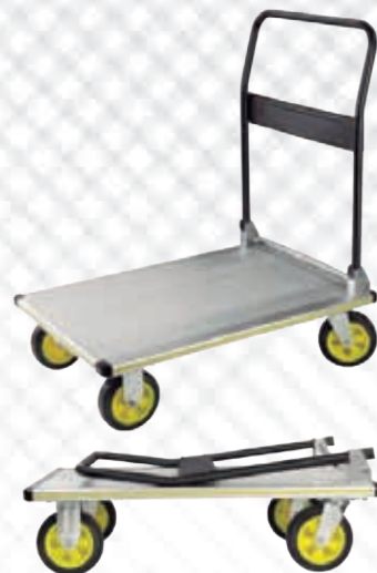
Cód. 102123 CARRO PLATAFORMA ALUMINIO PLEGABLE. NIVEL Carga: 300 kg. Peso: 18 kg..Altura: 101 cm. Asa de acero plegable y plataforma de aluminio. Plataforma: 60x90 cm. Plegado: 60x90x32cm. Ruedas de goma. Ø 18 cm. 88,50€ + 18,59 IVA = 107,09€
