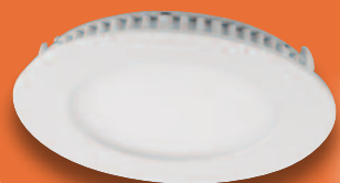
Cód. 99663 FOCO DOWNLIGHT LED REDONDO MEGALED Empotrable 20 W. Neutro, tipo de LED SMD de 20 W. 4000K, 120°, 25000 h. de vida útil. Aluminio. Medidas downlight: 225 (taladro). Equivale a 2x26 (CFL).
